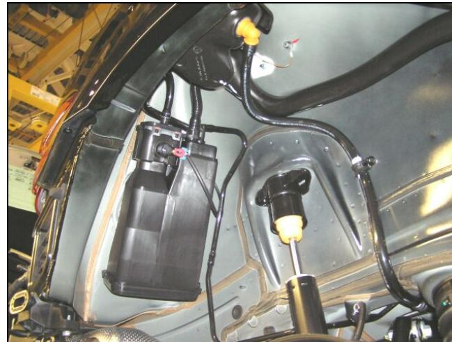
На автомобилях с бензиновыми двигателями применяется система отвода воздуха из топливного бака с емкостью с активированным углём (абсорбер), который устанавливается в правой задней колёсной нише.
