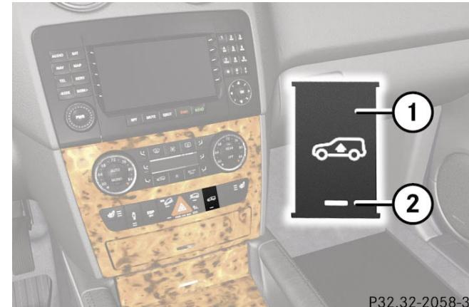
При помощи клавиши (N72/1s2) можно изменять уровень автомобиля (пневматическая подвеска код специальной комплектации 489)
