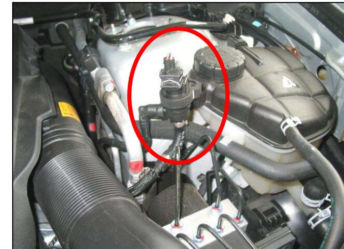
Абсорбированные углеводороды поступают во впускной коллектор двигателя через электроуправляемый клапан регенерации, который расположен в моторном отсеке.
