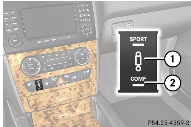
При помощи клавиши (N72/1s3) клиент может установить три степени демпфирования. Существует три положения системы.
