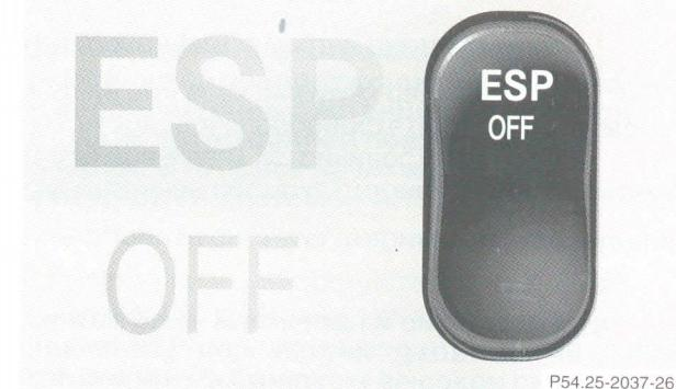
Переключатель находится на средней консоли. При движении с цепями противоскольжения, по глубокому снегу, песку или гравию положительную роль может играть выключение функции стабилизации движения. В этом случае крутящий момент двигателя не ограничивается и ведущие колеса могут прокручиваться, создавая фрикционное действие.
