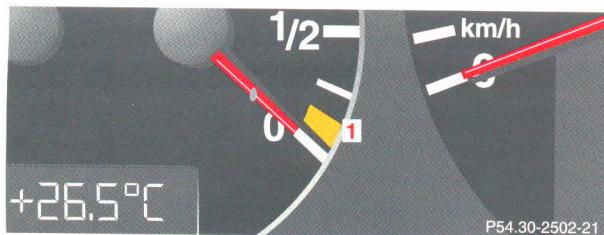
Если предупредительная сигнальная лампа (1) на указателе уровня топлива загорается при работающем двигателе, значит, достигнут минимальный резерв топлива.
