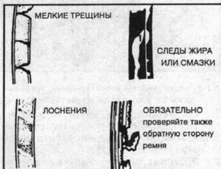
11.3 Некоторые из наиболее часто встречающихся дефектов приводных ремней (проверяйте состояние ремней очень тщательно во избежание их преждевременного разрыва)
