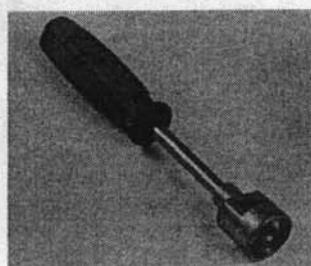
Инструмент для снятия шляпок пружин тормозных башмаков
