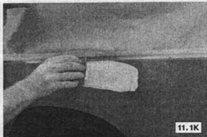
11 Грунтовка поможет выявить дефекты или царапины. Заполните их полировальной пастой. Следуя инструкциям на упаковке, обработайте ее тонкой (№ 360 или 400) наждачной бумагой до гладкости. Повторите полировку, нанося полировальную пасту и шлифуя ее, до тех пор, пока загрунтованная поверхность не станет абсолютно гладкой
