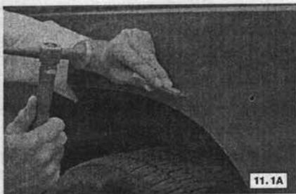
1 При отсутствии доступа к задней стороне панели кузова для выстукивания вмятины, ее следует вытянуть с помощью молотка со скользящим бойком. В самом глубоком месте вмятины, или вдоль ее границы, на сверлите или набейте небольшие отверстия на расстоянии не менее 2,5 см друг от друга...
