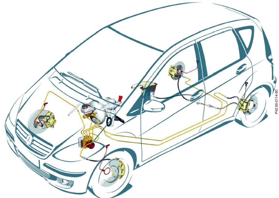
Усиление тормозной силы осуществляется за счет обычного 8" вакуумного усилителя.
