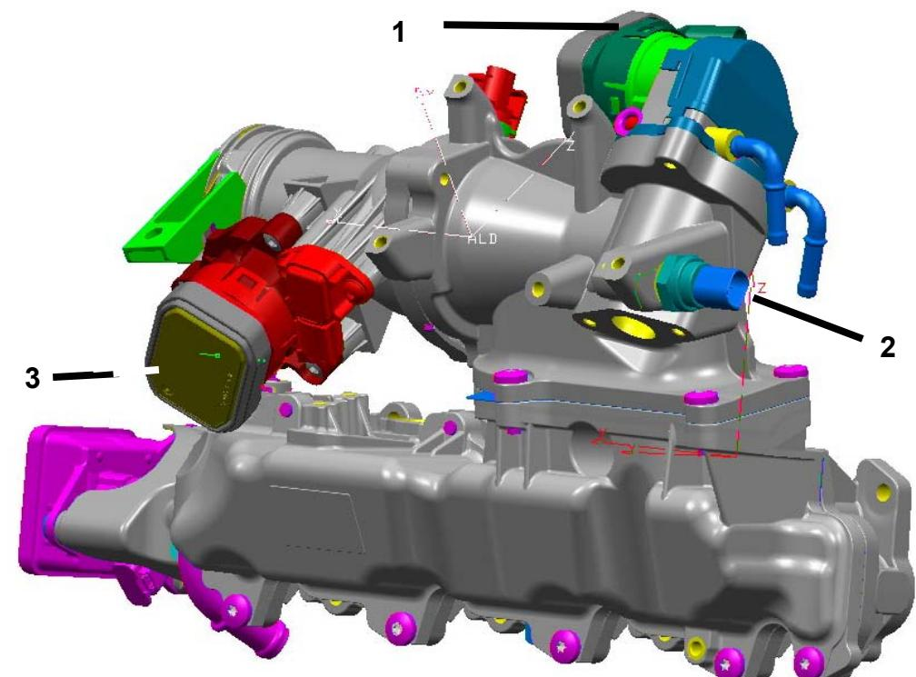
1 Электрический клапан рециркуляции отработавших газов с водяным охлаждением
